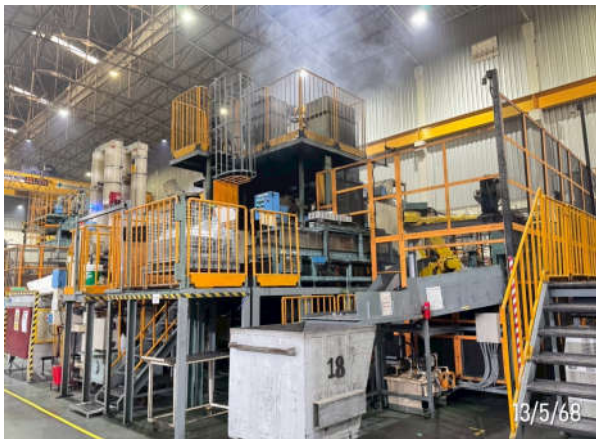
เครื่องฉีดขึ้นรูปอะลูมิเนียม (Die Casting Machine)
